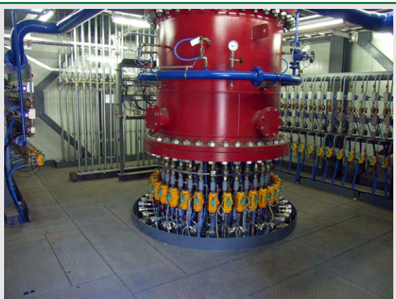
Сосуд-распределитель на 32 пневмопровода
