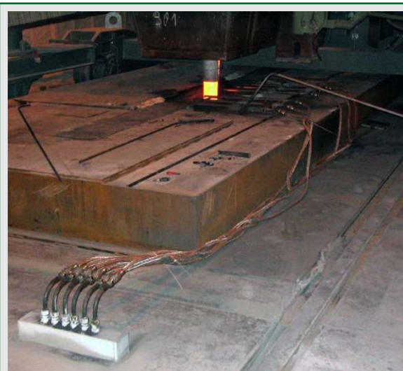
Пневмотрубопроводы к шестиструйному распределителю ШОС на МНЛЗ для производства слэбов
